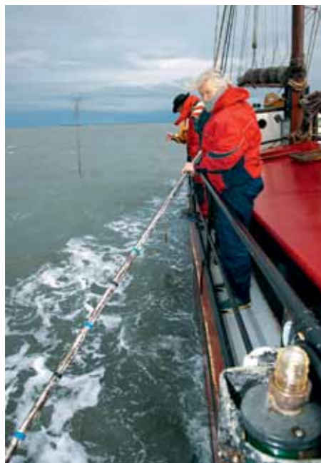
Loten von Hand, mit Senkblei und Stange. Während des Lehrtörns bleiben elektronische Geräte wie Echolot und Plotter abgeschaltet
